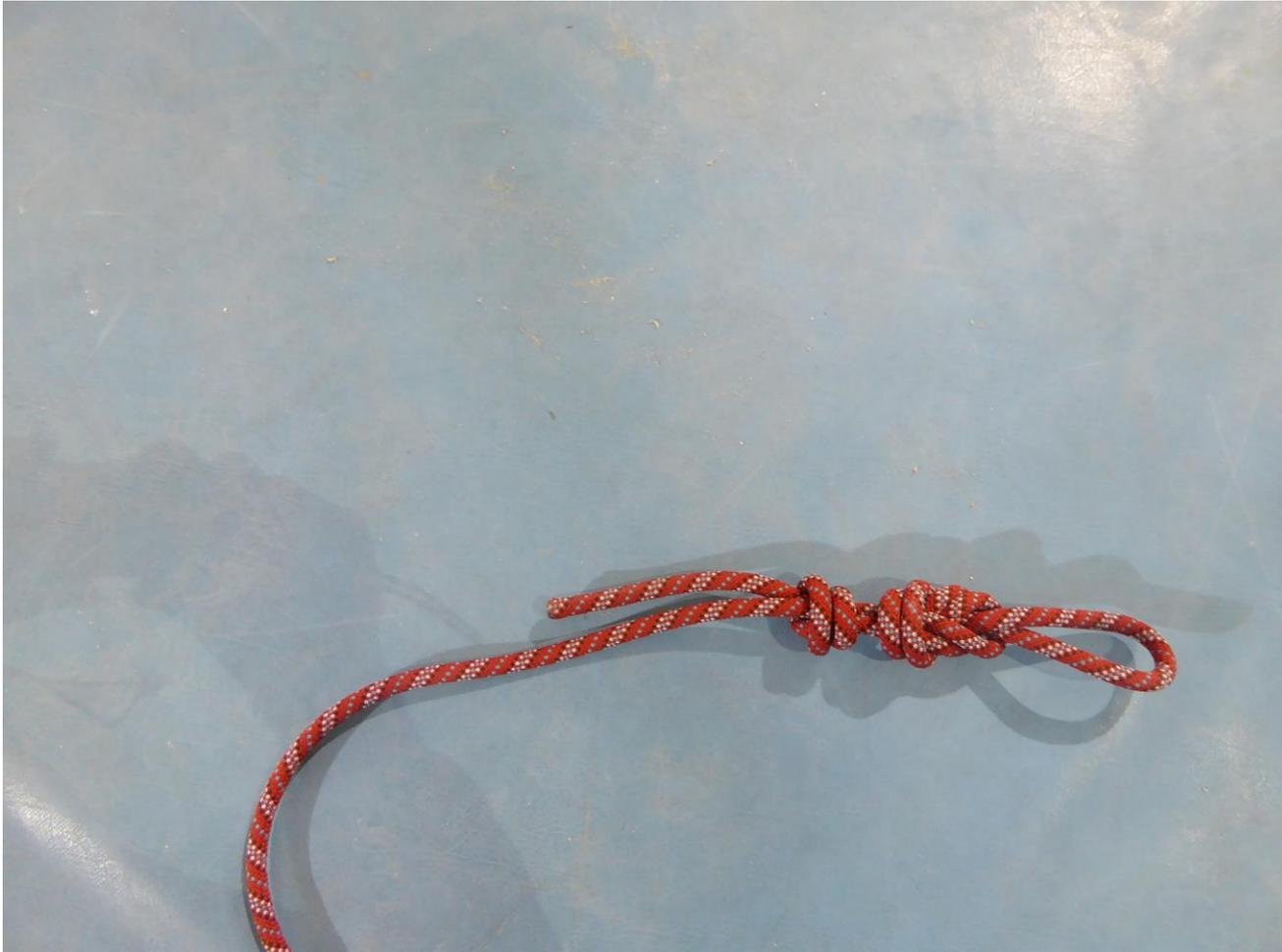
**Sur l'autre extrémité de la corde, installer son système autobloquant et confectionner un double 8 avec nœud de sécurité.**
